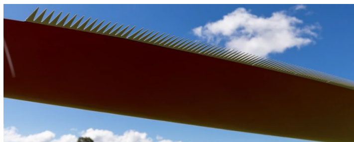
Figure 5 : Ajout de dentelures sur une pale d'éolienne afin de limiter l'impact acoustique
